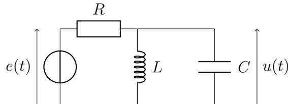
1. Calculer  $\underline{u}$  en fonction de  $\omega$ ,  $R$ ,  $L$ ,  $C$  et  $E$ . On posera  $Q = RC\omega_0$  et  $\omega_0 = \frac{1}{\sqrt{LC}}$ .
