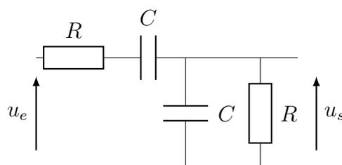
1. A quelles conditions sur la pulsation  $\omega$  le module de l'impédance d'un condensateur de capacité  $C$  est-elle très inférieure ou très supérieure à celle d'une résistance  $R$ ? Pour quelle pulsation  $\omega_0$  est-il égal à  $R$ ?
